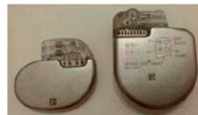
Porovnanie veľkosti kardiostimulátora a ICD, vľavo kardiostimulátor, vpravo ICD.
